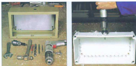
Figuur 5: Terwijl bij het aanpassen van een plaatstalen behuizing een hele gereedschapskist nodig is, voldoet bij de kunststof modellen een simpele conische boor.
