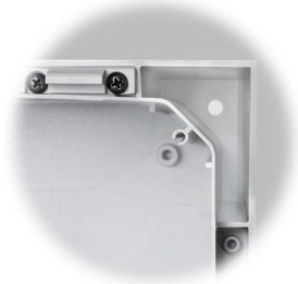
Figuur 4: Het dubbelwandige hoekontwerp stabiliseert bovendien de behuizing, en omdat het wandmontagegat is gelegen buiten de waterdichte zone het gebied van de pakking, blijft de beschermingsgraad in stand.
